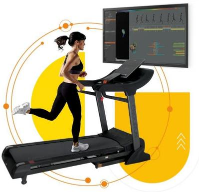
La **cinta de correr baropodométrica RunTime**, con una superficie de apoyo totalmente sensorizada, permite un análisis preciso de las presiones plantares, detectando la distribución de carga en la superficie durante las fases de marcha y carrera.
