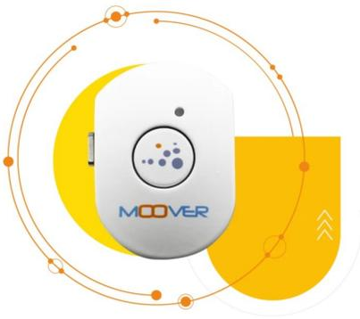
**Sensor de movimiento Moover** para la medición de movimientos, aceleraciones y rotaciones en el espacio.
