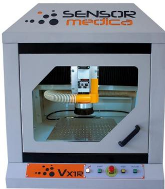
**Fresadora de 3 ejes CNC Vulcan VX1 Replica de Sensor Medica**, diseñada exclusivamente para la producción personalizada y en serie de plantillas ortopédicas computarizadas.
