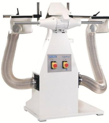
**Máquina lijadora/cepilladora - TP-2 de Ortomac**, para talleres de ortopedia y podología, provista de rosca de 5/8 en el eje de la derecha, para acoplar los distintos accesorios y preparada para la conexión de colector auxiliar. 120 Ø
