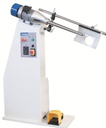
**Máquina fresadora con frenos de seguridad y variador de seguridad - TP-8FV de Ortomac.** Al disponer de variador de velocidad, se consigue un control total en las revoluciones de la máquina para un mejor acabado en el trabajo.
