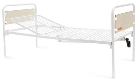
La **cama hospitalaria manual Ibisco 1** cuenta con **2 secciones y 1 articulación regulable mediante manivela**. Está fabricada en acero, con estructura de 4x2 cm recubierta con epoxi polvo y base de malla de acero soldada compatible con cualquier colchón.
