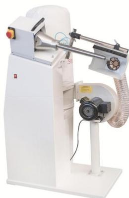
**Máquina fresadora/bruñidora con colector de aspiración y pie de soporte - TP-6C de Ortomac**, provista de eje cónico con rosca de 5/8 para la aplicación de fresas y demás accesorios, para lijar, fresar y pulir maderas, plásticos y espumas técnicas.
