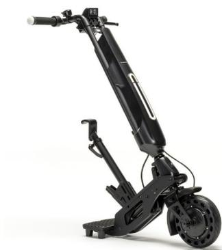
**Blumil GO es una solución única que permite transformar una silla de ruedas manual de chasis rígido en una bicicleta de mano eléctrica (handbike).**
